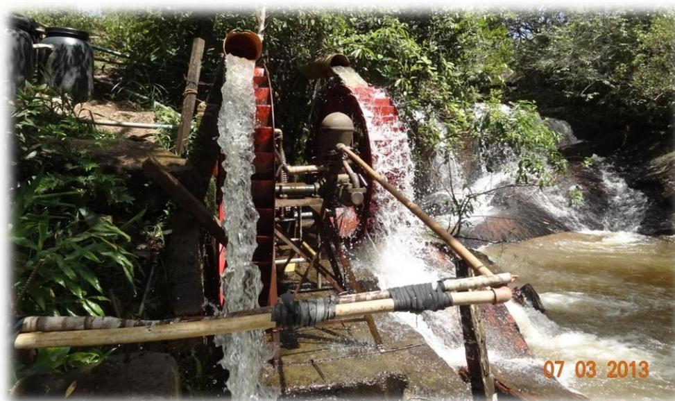
**Figura 64 - Roda de água que fornece energia hidráulica para conduzir a água até os habitantes contemplados do assentamento Itaqui e Patativa do Assaré.**
